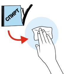
1. Предварительно обезжирить поверхность блока и подготовленное место на кузове автомобиля.
